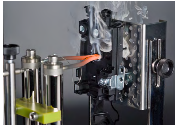
Glühdrahtprüfung (KADO) Glow wire test (KADO)
