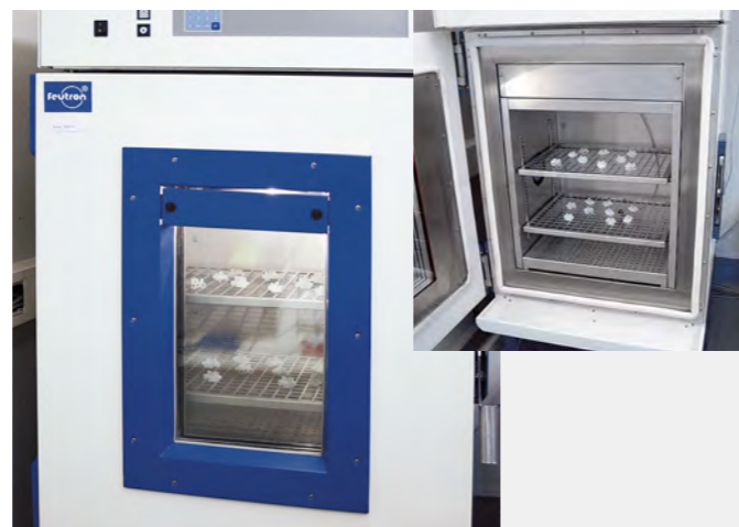
Klimakammer für Temperatur- und Feuchtigkeitslagerung Climate chamber for temperature and humidity storage
