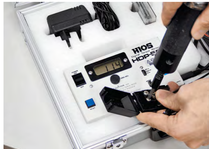
Drehmomentprüfung (KADO) Torque test (KADO)
