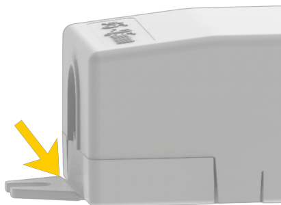
Sollbruchstelle an den seitlichen Laschen für einfaches Abbrechen - reduzierte Gesamtlänge für erleichtertes Einschieben in die Deckenöffnungen.
