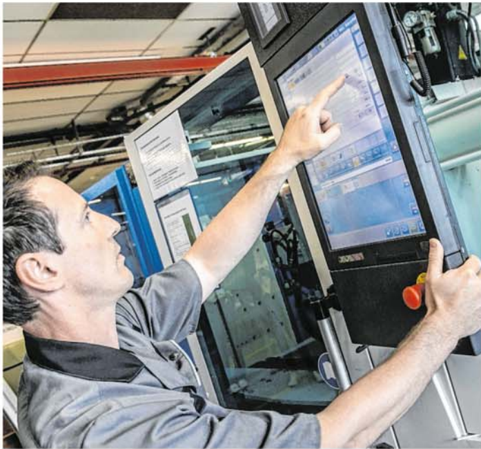
Robert Sillaber beim Einstellen der computergesteuerten Anlage für die Herstellung von Kunststoffteilen für die Lichtindustrie. (li.) Wie hier die Elektroklemmen, landen die Kunststoffteile dann verpackbereit in Auffangkörben (o.) Die Qualitätskontrolle erfolgt per Schublehre oder Kamera. Foto: Thomas Böhm
