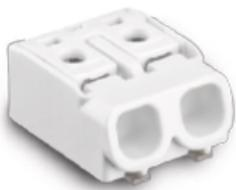
elektronischen Baugruppen in der Leuchte direkt mit Netzspannung zu versorgen, hat Electro Terminal die Leiterplattenklemme MICROCON SMD POWER entwickelt. Mit dem Bauteil, das eine Bauhöhe von nur 7 mm aufweist, wird ein einfacher Anschluss von 0,5 mm<sup>2</sup> – 2,5 mm<sup>2</sup> Leitern in starrer und flexibler Ausführung ermöglicht. Für hohe Strombelastungen beim
