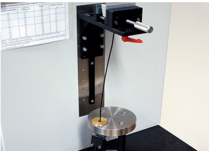
Drehprüfgerät zur Beurteilung einer zuverlässigen Verbindung Test equipment for checking the reliability of connections
