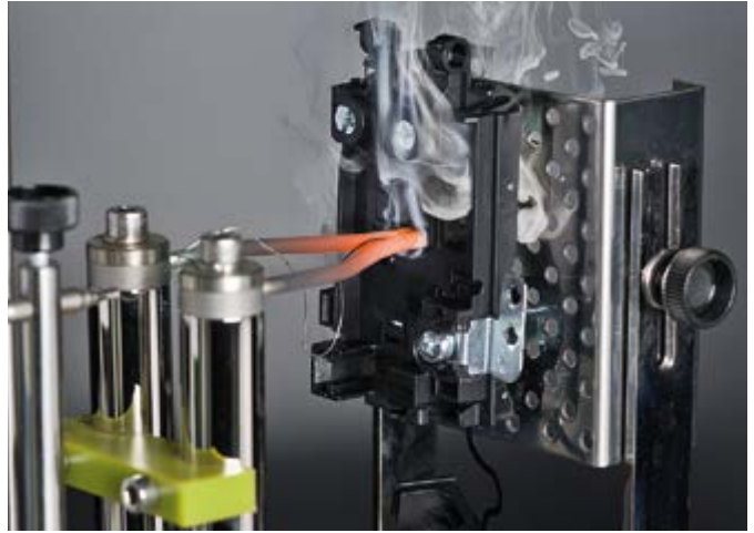
Glühdrahtprüfung (KADO) Glow wire test (KADO)
