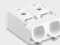
MICROCON SMDP Unsere „Starke“ für starre und flexi- ble Leiter von 0,5 mm 2 bis 2,5 mm 2 Our „strong one“ for solid and flexible wires from 0.5 mm 2 to 2.5 mm 2 CU, AWG 20 - 14 (SOL/STR)
