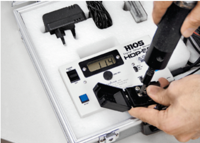
Drehmomentprüfung (KADO) Torque test (KADO)
