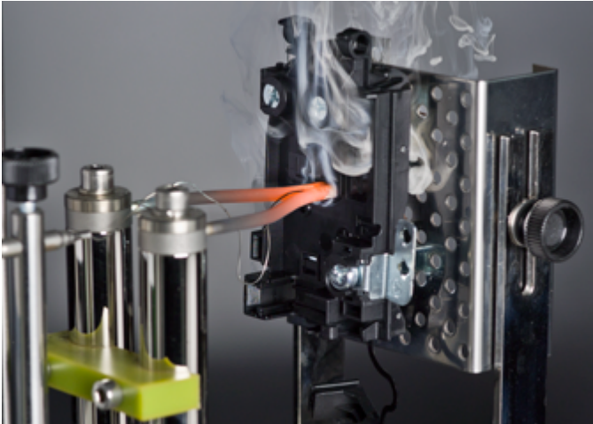
Glühdrahtprüfung (KADO) Glow wire test (KADO)
