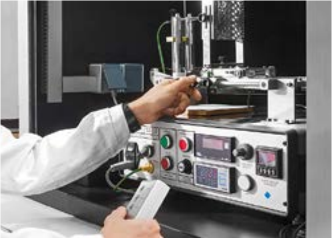
Glühdrahtprüfgerät Glow wire test device
