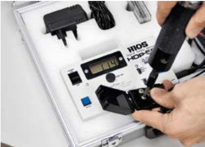
Drehmomentprüfung (KADO) Torque test (KADO)
