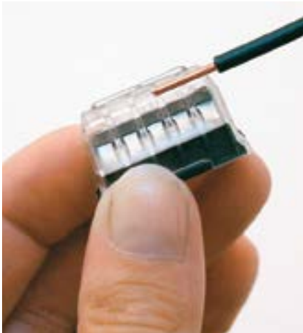
Leiter 8 – 9 mm abisolieren Strip wire 8 – 9 mm
