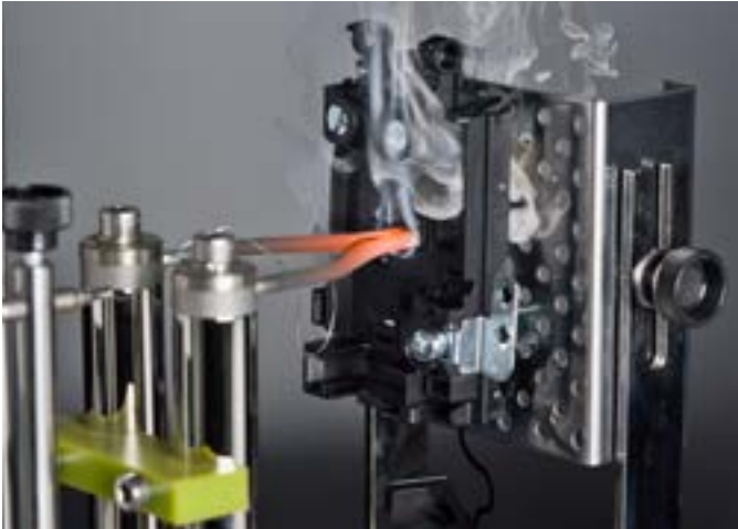
Glühdrahtprüfung (KADO) Glow wire test (KADO)
