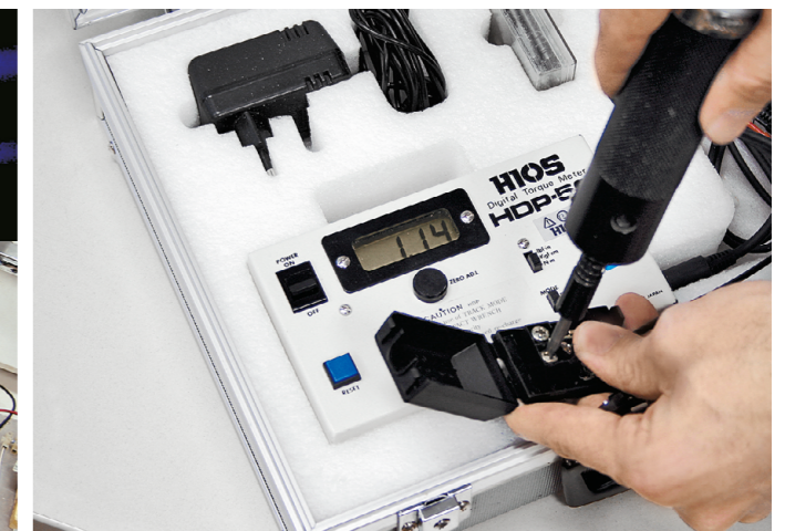
Drehmomentprüfung (KADO) Torque test (KADO)
