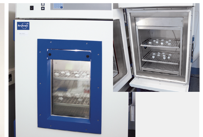
Klimakammer für Temperatur- und Feuchtigkeitslagerung Climate chamber for temperature and humidity storage
