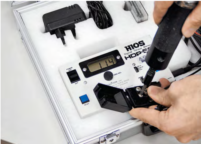
Drehmomentprüfung (KADO) Torque test (KADO)
