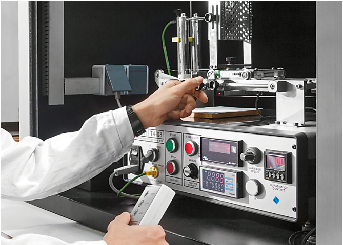
Glühdrahtprüfgerät Glow wire test device
