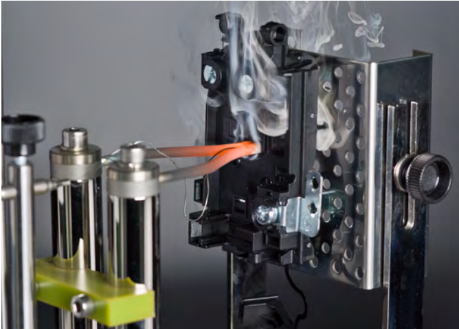
Glühdrahtprüfung (KADO) Glow wire test (KADO)
