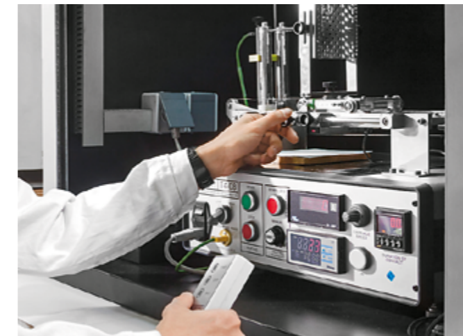
Glühdrahtprüfgerät Glow wire test device
