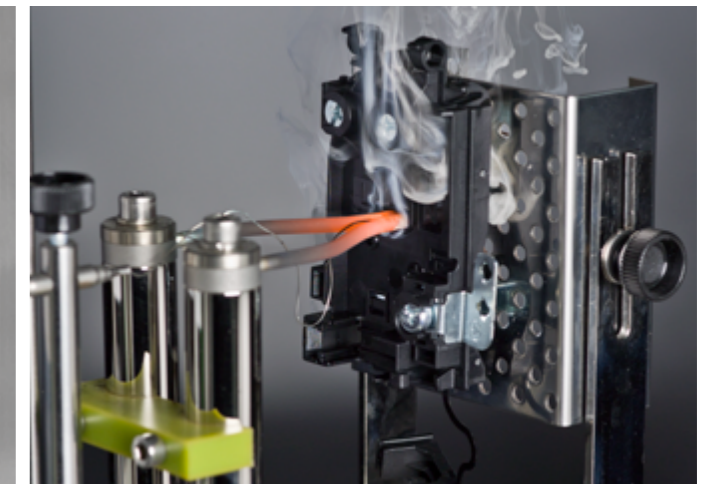
Glühdrahtprüfung (KADO) Glow wire test (KADO)
