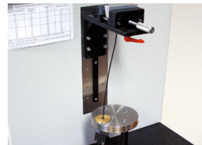
Drehprüfgerät zur Beurteilung einer zuverlässigen Verbindung Test equipment for checking the reliability of connections
