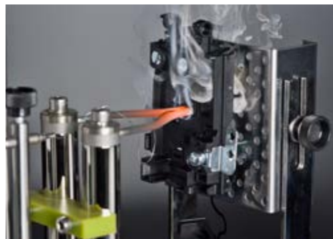
Glühdrahtprüfung (KADO) Glow wire test (KADO)
