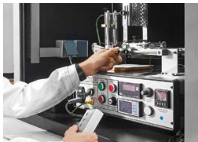
Glühdrahtprüfgerät Glow wire test device
