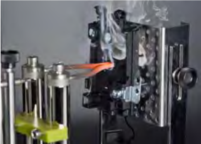
Glühdrahtprüfung (KADO) Glow wire test (KADO)
