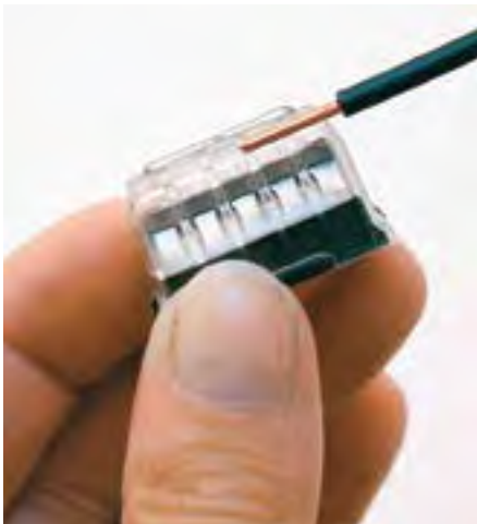
Leiter 8 – 9 mm abisolieren Strip wire 8 – 9 mm
