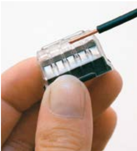
Leiter 8 – 9 mm abisolieren Strip wire 8 – 9 mm
