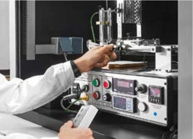
Glühdrahtprüfgerät Glow wire test device
