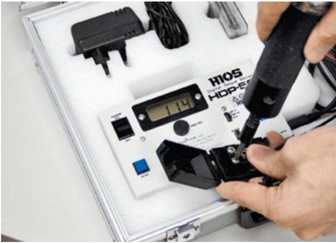
Drehmomentprüfung (KADO) Torque test (KADO)
