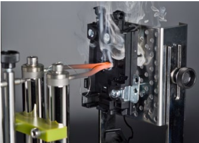
Glühdrahtprüfung (KADO) Glow wire test (KADO)
