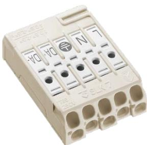
Dabei ist die neue Leuchtenanschlussklemme auch überaus komfortabel in der Handhabung. Selbst bei dieser Bauhöhe sind die oberen Anschlüsse mittels Drücker lösbar. Sie können hier sowohl flexible als auch starre Leiter von 0,5 bis 2,5 mm<sup>2</sup> verwenden. Die unteren Anschlüsse sind für eindrätige Leiter geeignet. Diese können durch einfaches Drehen und Ziehen gelöst werden.
