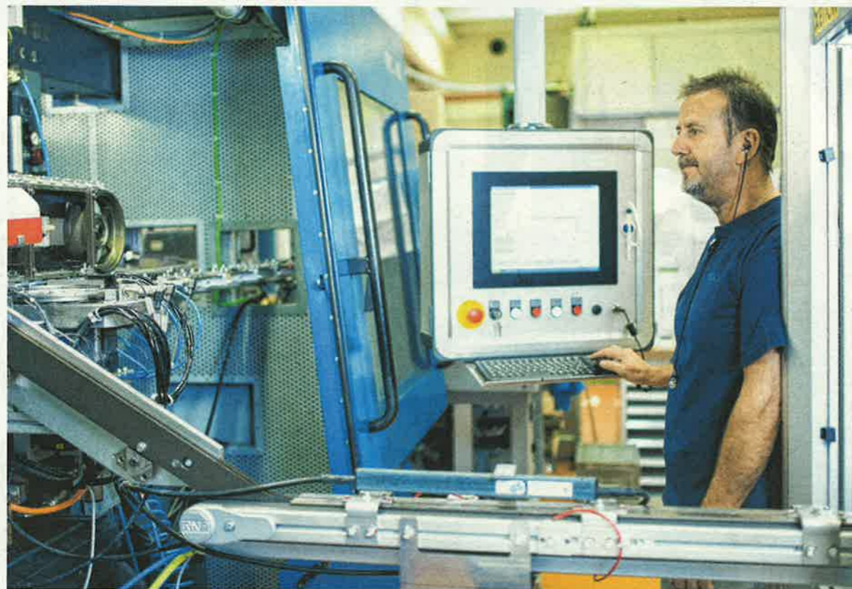
Geballte Kompetenz: Stanzbiegemaschine mit Montageeinheit
