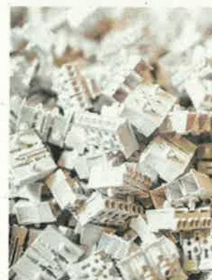
Kunststoffgehäuse für Leuchtenanschlussklemmen
